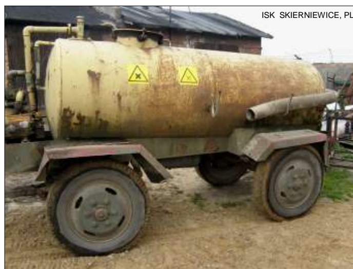
Rys. 39 Zbiornik do przechowywania płynnych pozostałości do czasu ich wykorzystania lub bezpiecznej utylizacji musi być wyraźnie oznaczony
