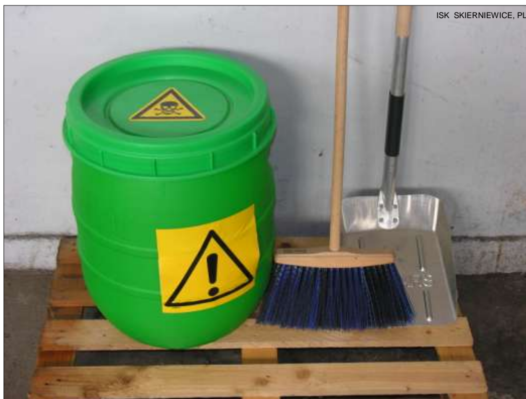
Rys. 40 Pojemnik na skażone pozostałości stałe powinien być wyraźnie oznakowany
