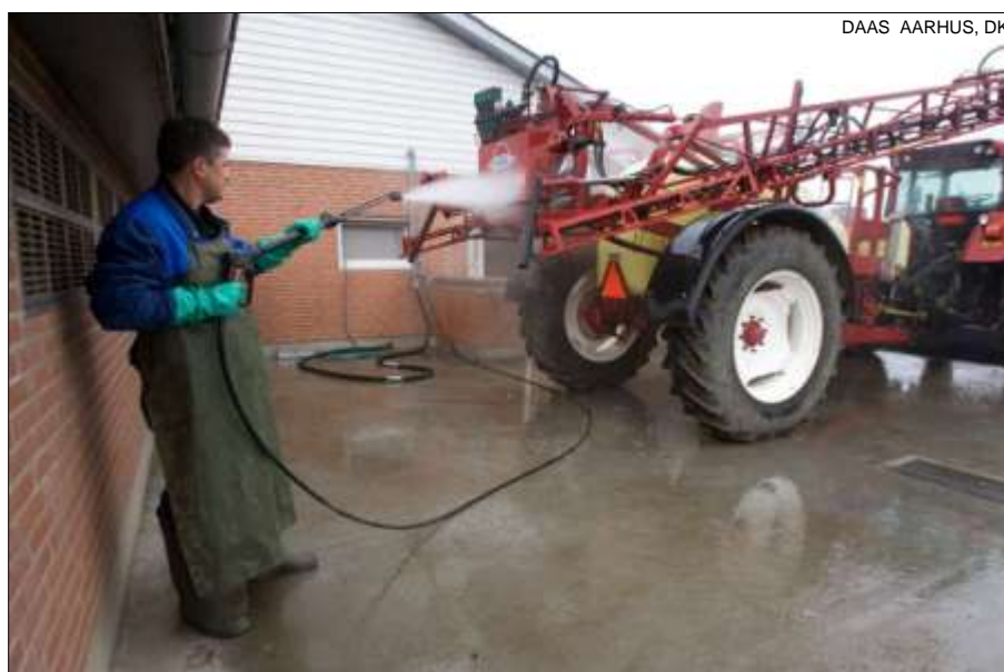
Rys. 31 Ciśnieniowe mycie zewnętrzne opryskiwacza na nieprzepuszczalnym podłożu
