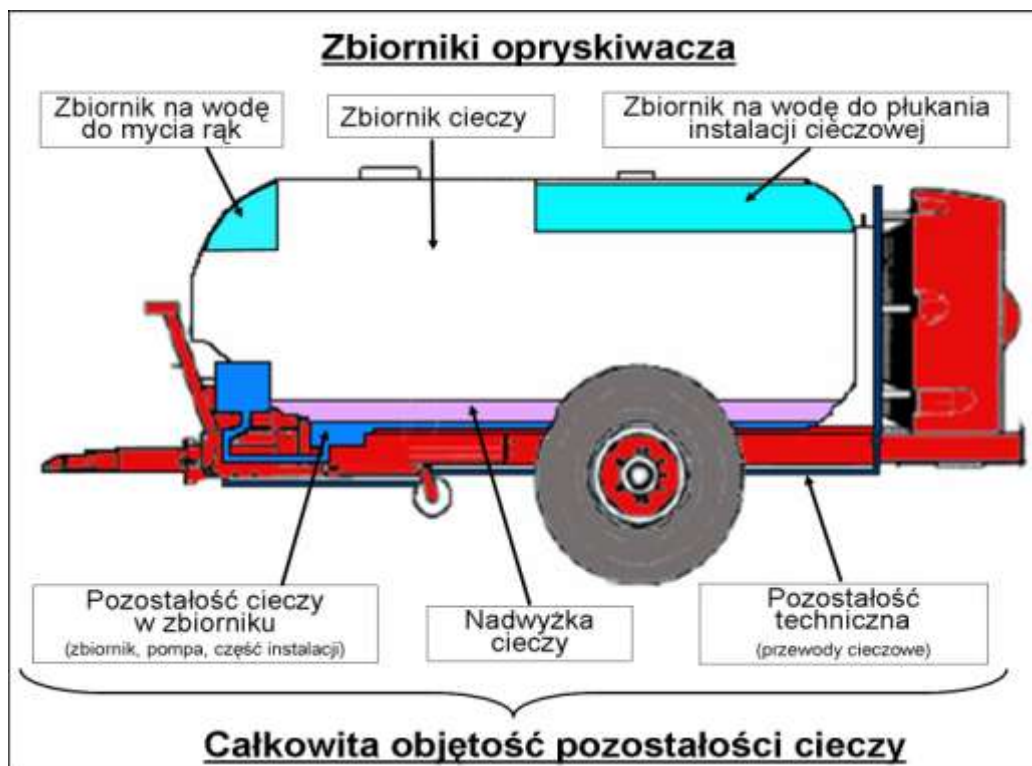
Rys. 27 Całkowita objętość pozostałości cieczy w opryskiwaczu zależy od dokładności jego kalibracji i konstrukcyjnego rozwiązania instalacji cieczowej
