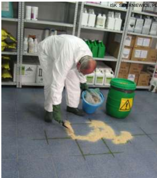
Rys. 7 W magazynie powinny znajdować się środki do likwidacji skutków rozlania i rozsypania preparatów
